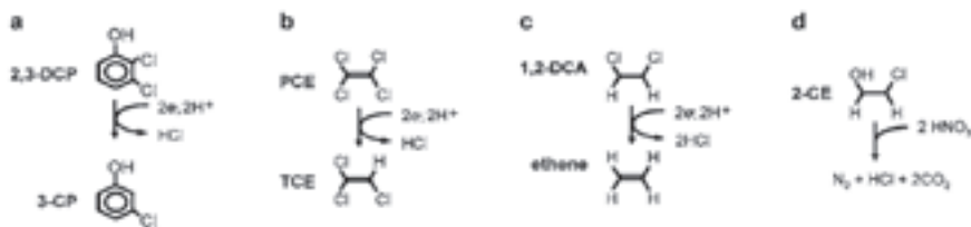
Slika 3.. Različite mehanizmi anaerobne dehalogenacije (a, b) Reduktivna hidrogenolitička dehalogenacija od 2,3-dihlorofenola (2,3-DCP) do 3-hlorofenola (3-CP), PCE trihloroetene (TCE), (c) redukcijaska dihaloeliminacija 1,2-DCA, (d) potpuna oksidacija 2-hloroetanol (2-CE) uz redukciju nitrata (Smidt i de Vos 2004).
